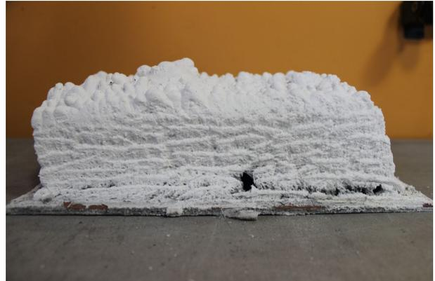
**Abb. 6: Brandschutzbeschichtungen bilden im Brandfall einen isolierenden Kohlenstoffschaum, der die Erwärmung des Stahlbauteils verzögert.**
